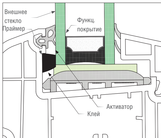
Устройство створки со вклеенным остеклением
