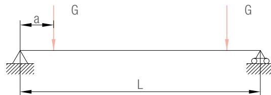
Рисунок 9: схема нагружения поперечины нагрузкой от собственного веса заполнения
