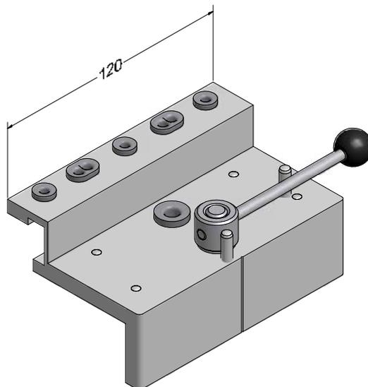
Шаблон для механического соединения,
