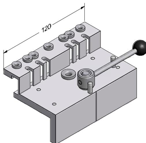
Шаблон для механического соединения,
