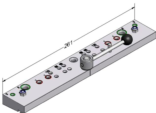
Шаблон для механического соединения
