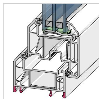
Крепление несущих деталей фурнитуры в 2 стенки ПВХ профилей или дополнительно в металл гарантирует надёжную передачу веса створки на армирование коробки.
